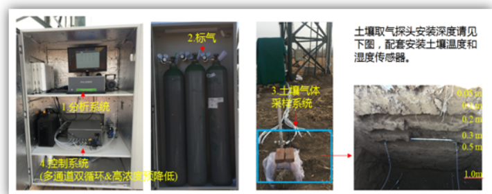
梯度扩散测定装置在野外的原位安装测试
