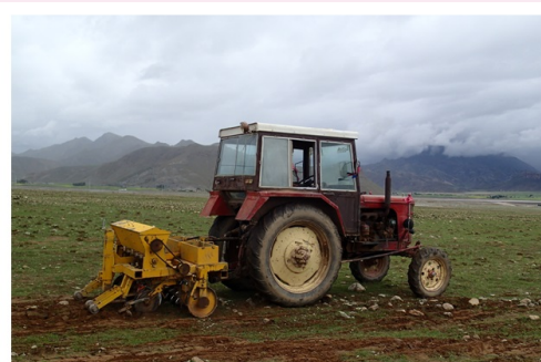
采用可越障式免耕补播机补播中度退化放牧草地
